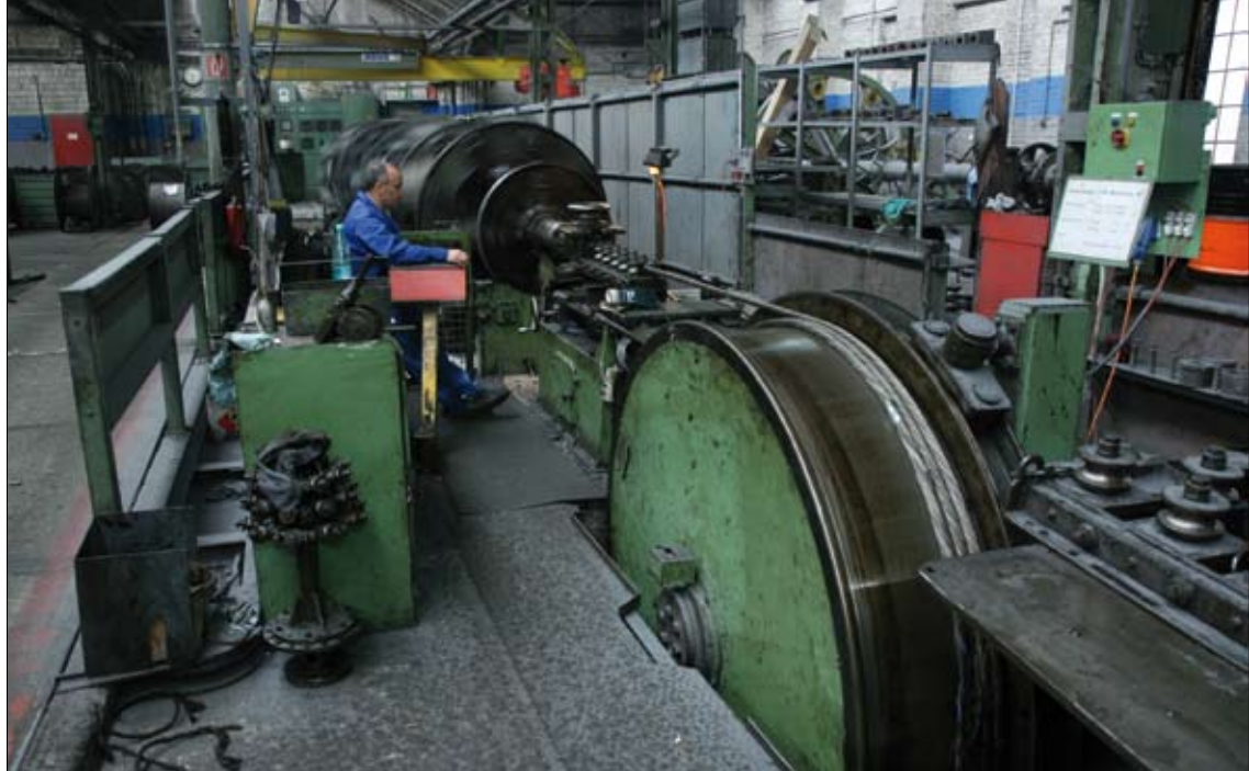
Abb. 1: Auf Maschinen wie dieser Korbverseilmachine werden im WDI-Werk Dortmund jährlich etwa 600 t Stahlseile hergestellt. Über 1 Mio. m davon gehen in die Forstwirtschaft.
