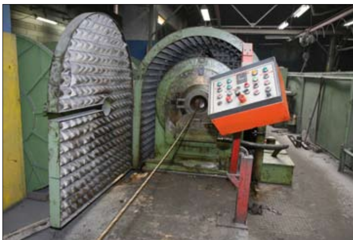
Abb. 3, rechts: Auch das neue Forstseil Python 6 R+F wird im Ganzseilverfahren verdichtet.
