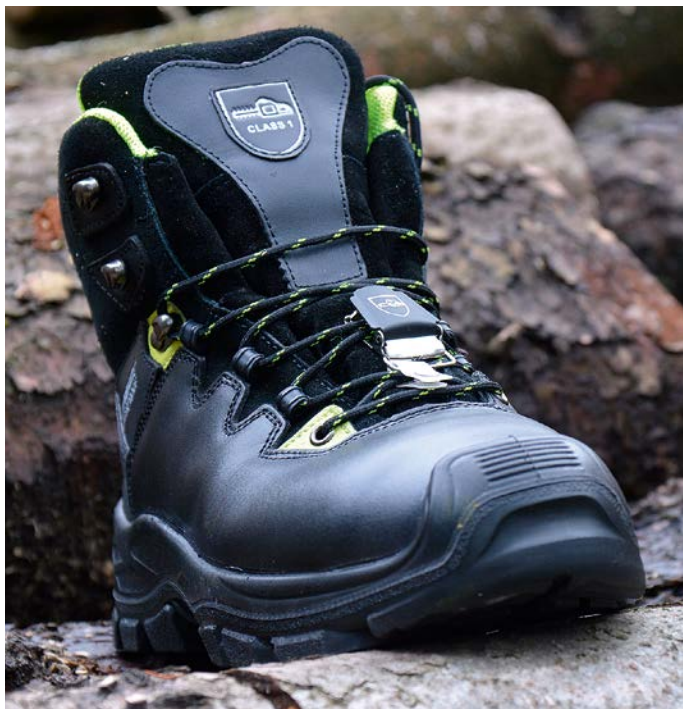
Der durch Schnittschutzmaterial geschützte Bereich reicht von der Mitte der Lederfaltlasche jeweils sieben Zentimeter nach außen. Der Spann ist komplett geschützt, bis zur Stahlkappe. Fotos: Riemann
