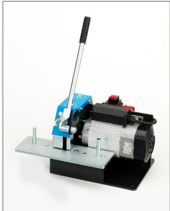
Die Schlauch-Trennmaschine T 250 A ist eine einfach und sicher zu bedienende Tischmaschine für die Service-Werkstatt.
